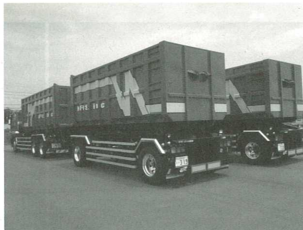
回収・出荷用フルトレーラー
